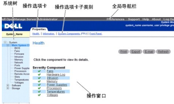
图 3-2 显示具有管理员权限的用户在模块化系统上登录时的 Server Administrator 主页的样式。
